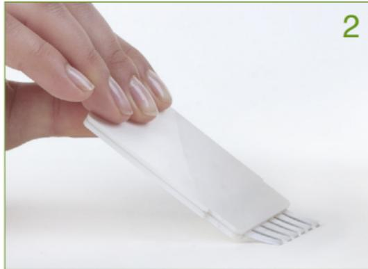
Wischen Sie mit dem freien Ende der Teststreifen über eine oder mehrere verdächtige Oberflächen. **Wichtig:** Die Rückseite der Testkassette muss nach oben zeigen, so dass die raue Seite der Teststreifen die Oberflächen berührt.
